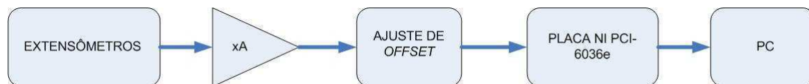
Figura 12: Diagrama de blocos representativo do esquema de comunicação entre sensor e microcomputador.
