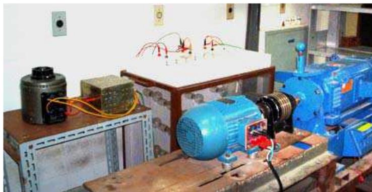
Figura B.3 – Motor de indução trifásico, gerador CC e carga resistiva utilizados como carga para o inversor.
