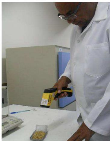
Figura 3.8 - Medição da temperatura dos grãos logo após a retirada da bandeja de dentro da estufa.
