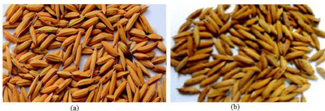
Figura 4.17 - Grão com teor de umidade de 34%, (a) antes e (b) depois da secagem na temperatura de 60°C.
