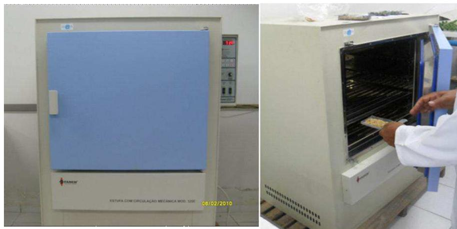
Figura 3.2 - Estufa com circulação mecânica de ar de fabricação da FANEM mod. 320E com controlador digital de temperatura.
