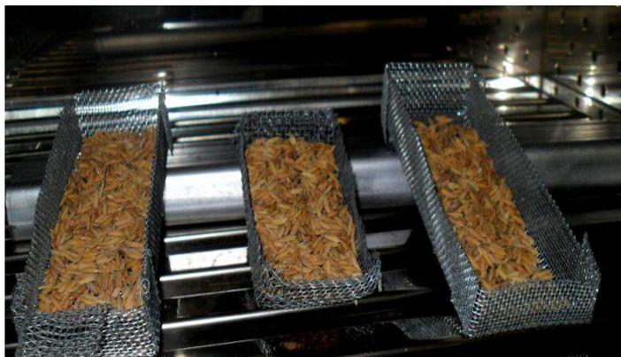
Figura 3.9 - Amostra do arroz no interior das bandejas dentro da estufa.
