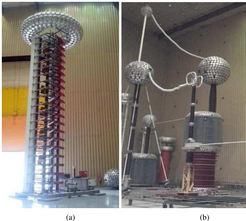
Figura 3. 3 – Fotografias de Gerador de impulso de tensão (a) e Transformador de alta tensão (b).
