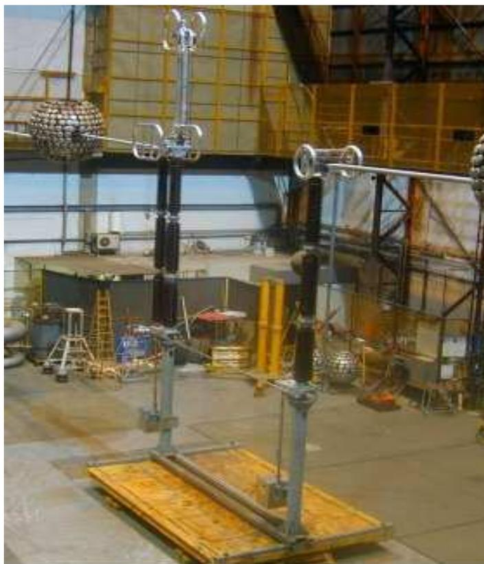
Figura 3. 1 - Fotografia de um seccionador de 550 kV pronto para ser ensaiado.
