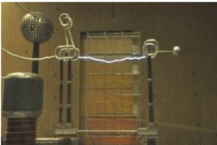
Figura 1. 1 - Fotografia de um seccionador com a disrupção dielétrica entre contatos.
