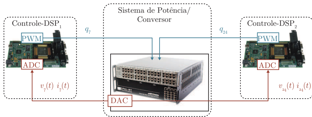
Figura 5.13: Circuito simplificado para representar a implementação do SEP e conversor no OPAL interagindo com os DSPs.
