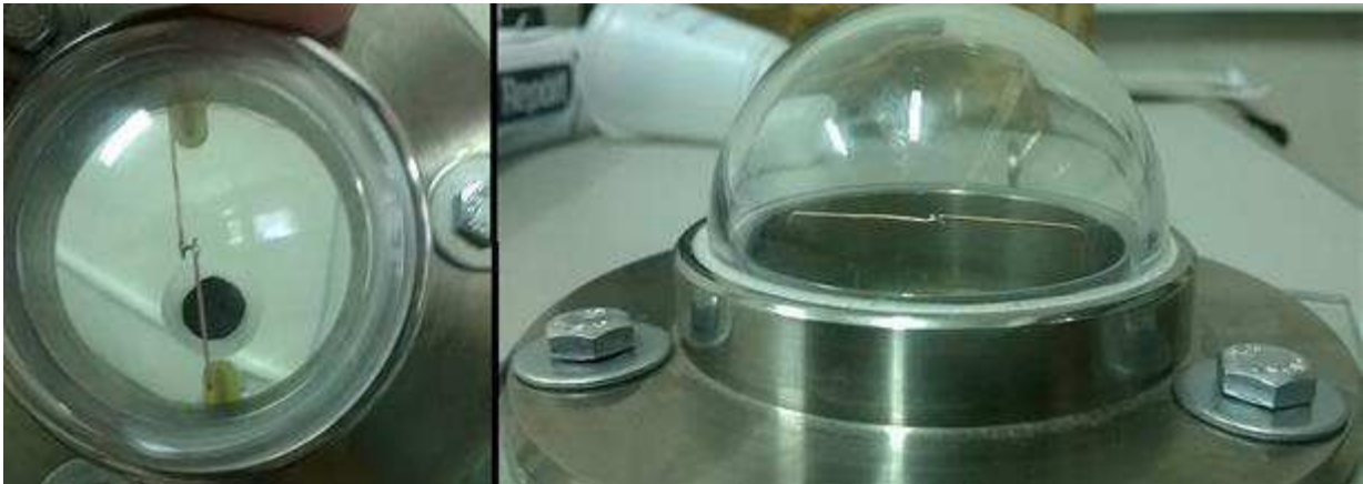
Figura 4 – Termistor NTC inserido em um hemisfério de vidro, no laboratório LIMC da UFCG.
