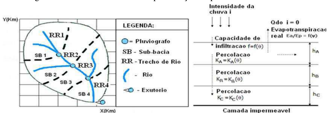
Figura 3.1– Estrutura da bacia e representação do perfil do solo no modelo
