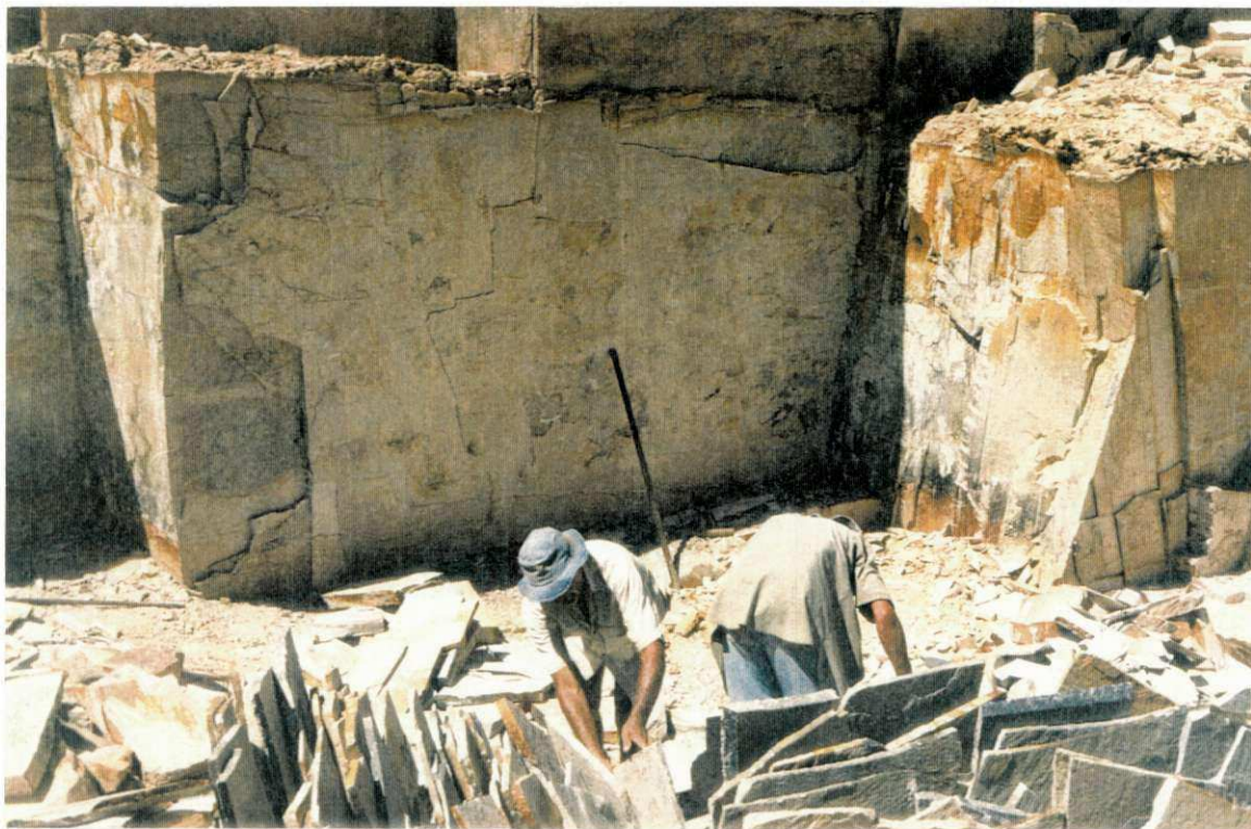
Figura 7 – Extração Manual de Quartzitos
