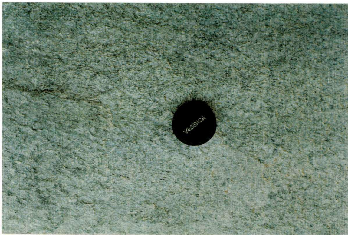
Figura 14— Granulação Fina nos Quartzitos de Várzea e Junco do Seridó, Paraíba.
