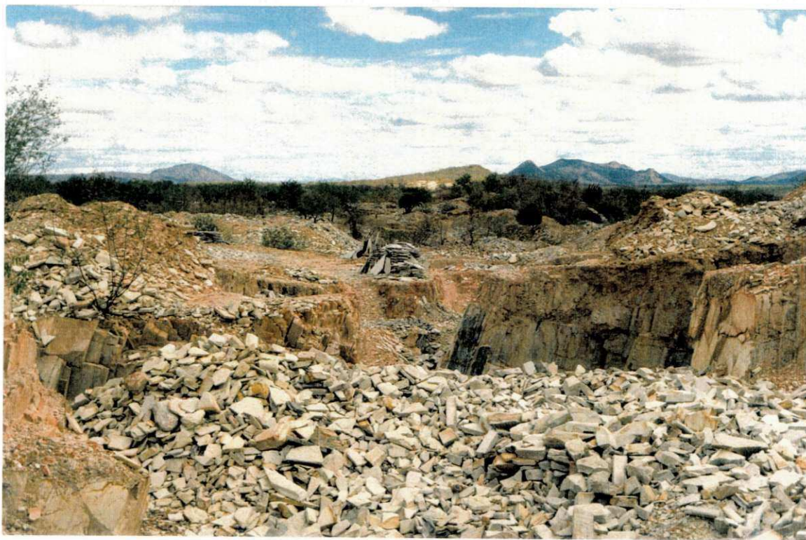
Figura 8 – Formação de Pilhas de Rejeitos na Cava
