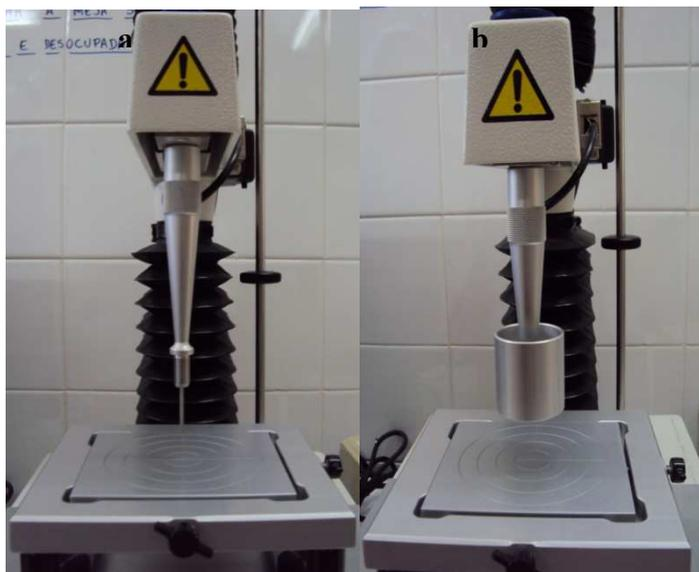
**Figura 3.4** - Probes utilizados nas análises de atributos de textura, **a**: P/2; **b**: P/32
