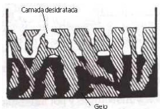
**Figura 2.1** – Estrutura porosa dos alimentos liofilizados
