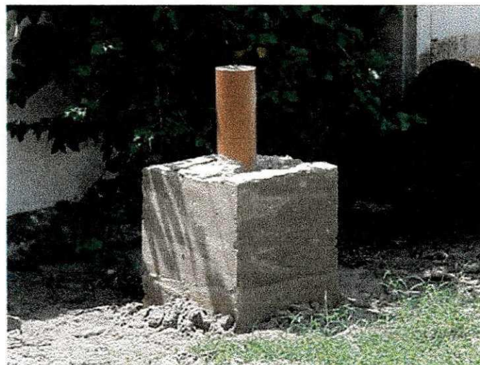
Figura 3.25 – Referência de nível do edifício Irineu Catão.
