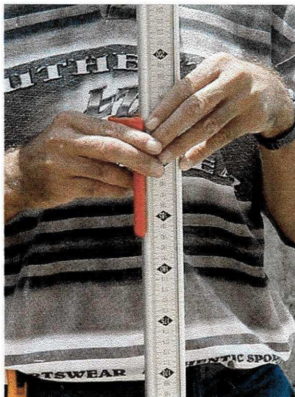
Figura 3.23 – Mira utilizada no monitoramento de recalques.
