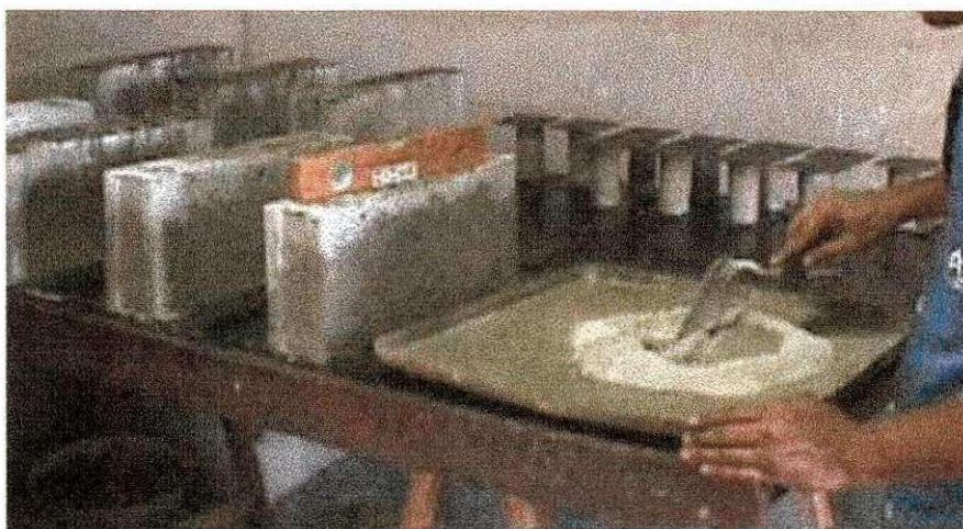
FIGURA 3.9 – Detalhe do capeamento dos corpos-de-prova e dos blocos.
