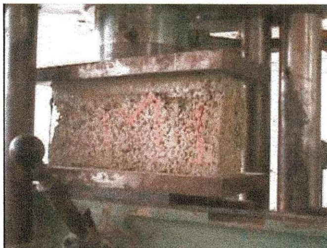
FIGURA 3.10 – Detalhe do bloco sendo rompido.
