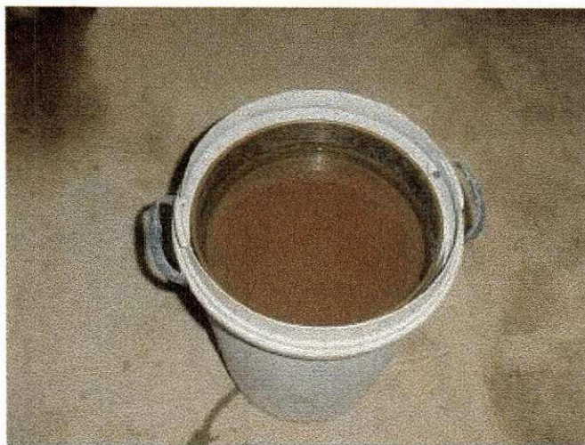
FIGURA 3.5 – Detalhe do recipiente usado na pré-molhagem do agregado de EVA, utilizando-se uma peneira para impedir a ascensão do agregado.
