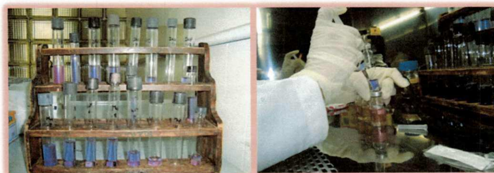
Figura 30: Inoculação das amostras de anaeróbios totais: (a) Diluição das amostras. (b) Injeção da amostra diluída nos tubos de penicilina
