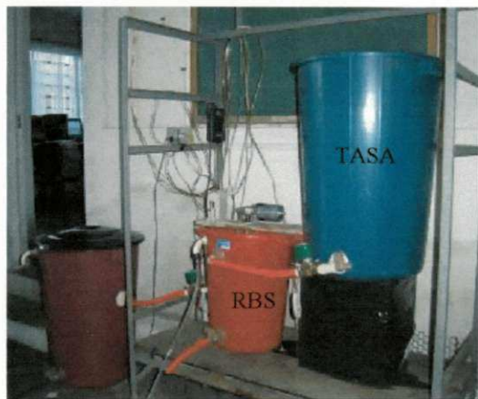
Figura 3.5 – Foto do sistema RBS-SA, destacando-se o tanque de armazenamento de substrato amoniacal (balde azul) e o reator RBS (balde vermelho).
