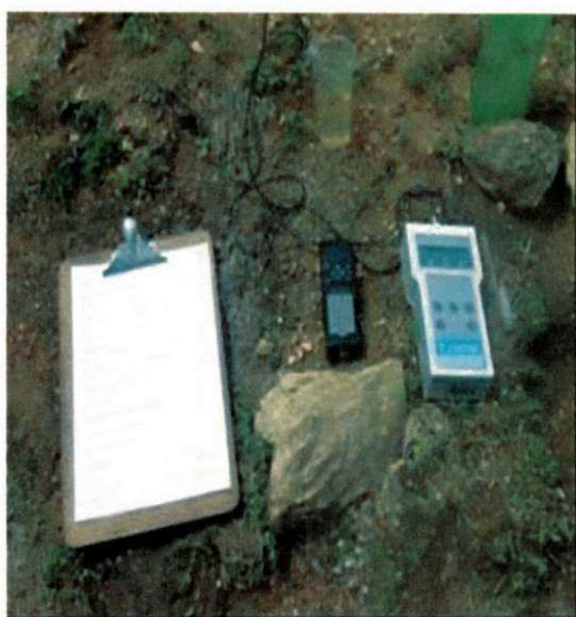
Figura 5c. Ficha de campo, GPS, Condutivímetro portátil utilizado na pesquisa Fonte: FUNASA, 2007
