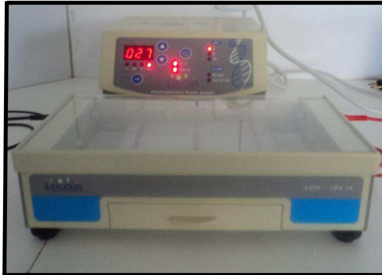
Figura 4: Equipamento de eletroforese horizontal em funcionamento acoplado a uma fonte de eletroforese.
