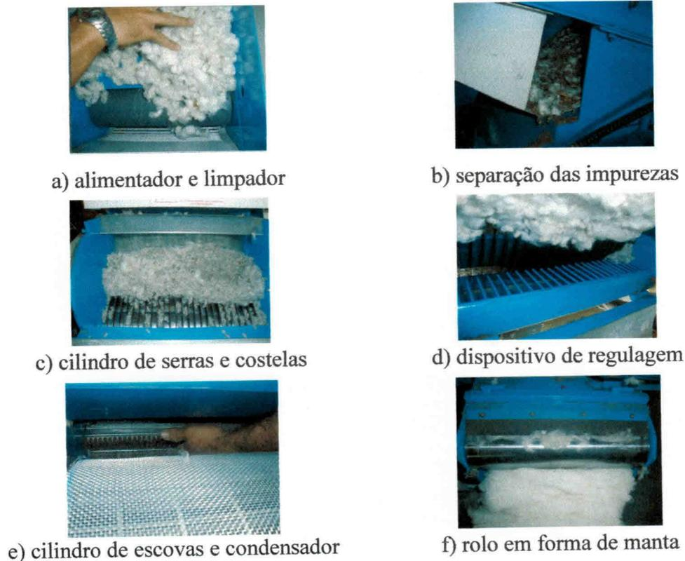
Figura 4.12. Fotos dos principais componentes do descaroador de 25 serras seqüenciando o seu funcionamento
