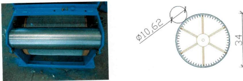
Figura 4.11. Foto e vista frontal do cilindro de tela e rolo
