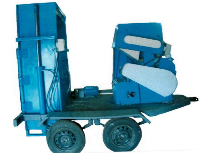
Figura 4.15. Foto da configuração final do conjunto descaroçador, prensa enfardadeira e reboque.
