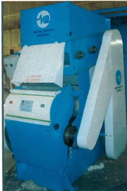
Figura 4.1. Foto do limpador e descaroçador de 25 serras
