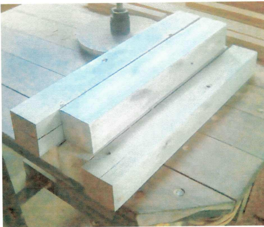
Figura 24 – Peças prismáticas da madeira de E. camaldulensis
