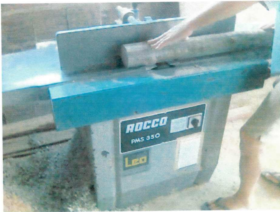
Figura 23 – Esquadreamento das toras em uma plaina
