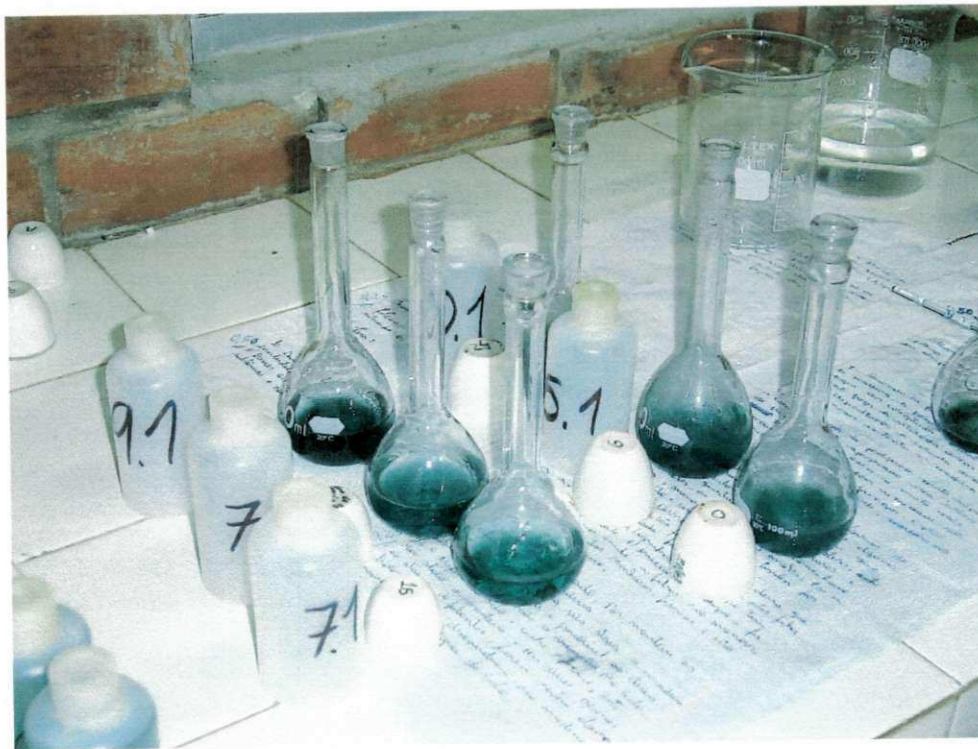
Figura 22 - Diluição das amostras digeridas em volumes fixos
