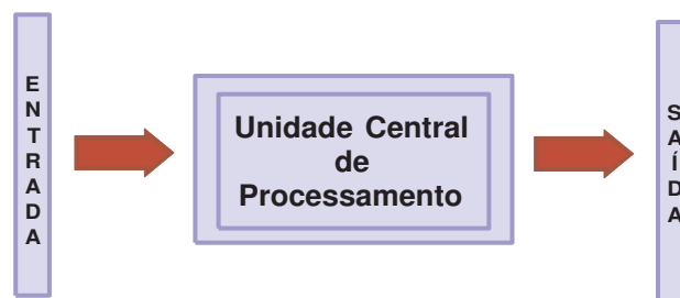
Figura 3.1: Estrutura básica de um CLP
