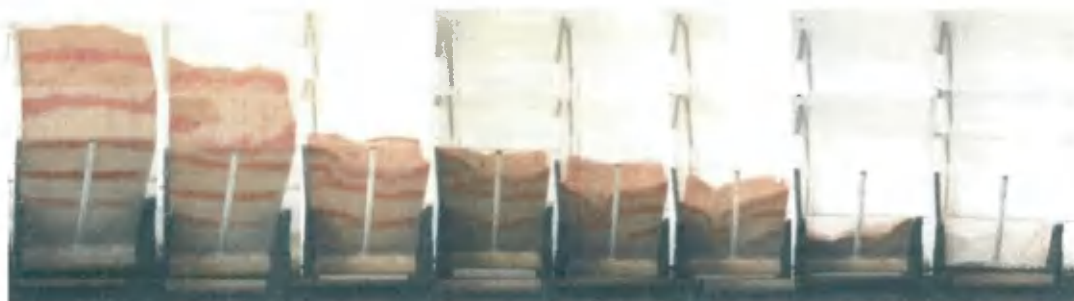
FIGURA 4.10 - Modelo de fluxo de massa utilizando transportador com passos variados, diâmetro externo constante e o eixo cônico.
