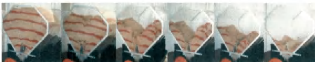
FIGURA 4.09 - Modelo de fluxo indeterminado utilizando transportador com passos variados, diâmetro externo constante e o eixo cônico.
