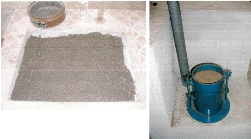
Figura 13 – Molde e soquete utilizados para realização dos ensaios de compactação.
