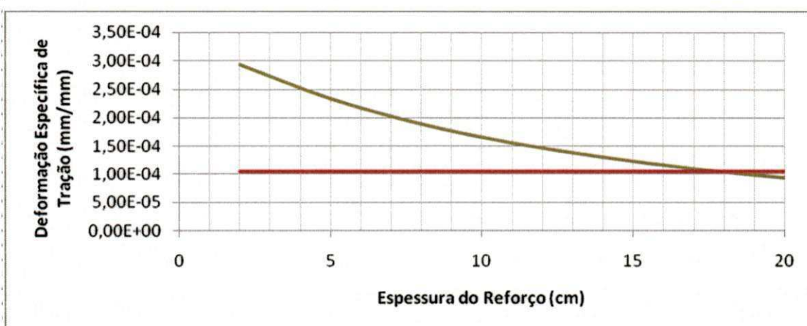
Figura 4.22 – Determinação da Espessura de Reforço Necessário para Garantir a Vida de Fadiga, Utilizando o Conjunto de Módulos Resultante da Retroanálise 6.
