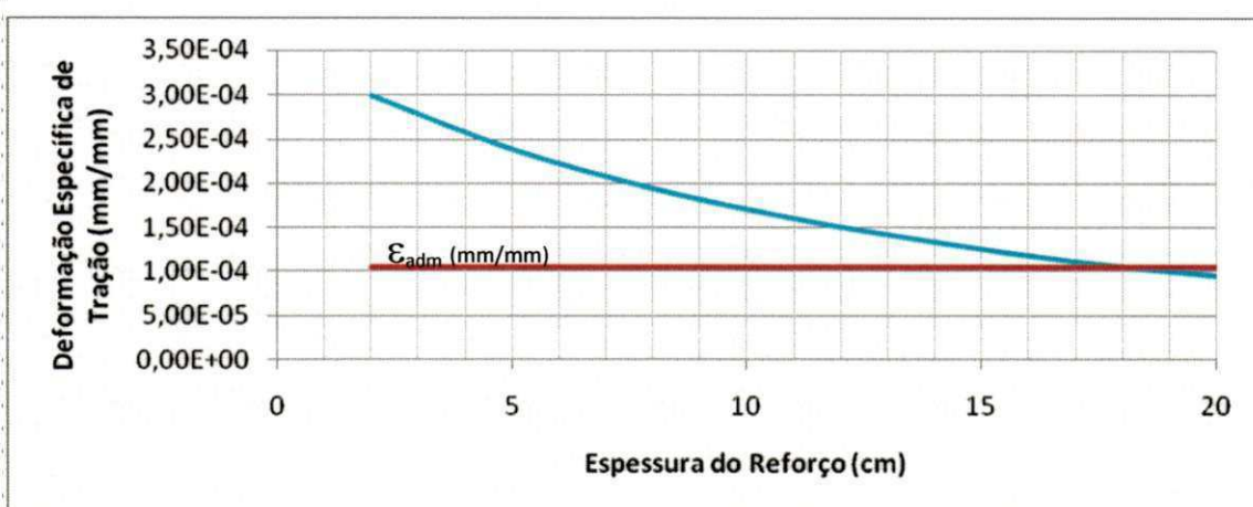
Figura 4.19 – Determinação da Espessura de Reforço Necessário para Garantir a Vida de Fadiga, Utilizando o Conjunto de Módulos Resultante da Retroanálise 3.
