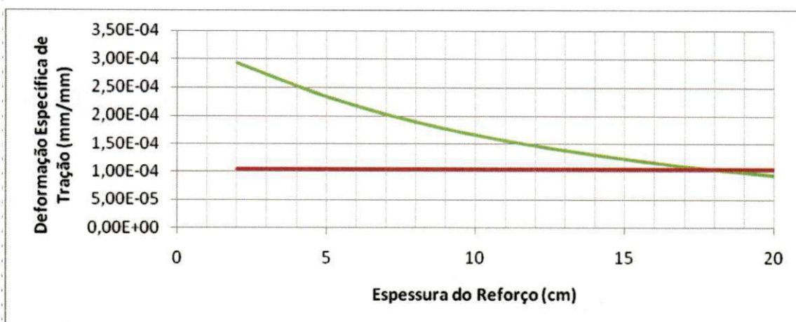
Figura 4.21 – Determinação da Espessura de Reforço Necessário para Garantir a Vida de Fadiga, Utilizando o Conjunto de Módulos Resultante da Retroanálise 5.
