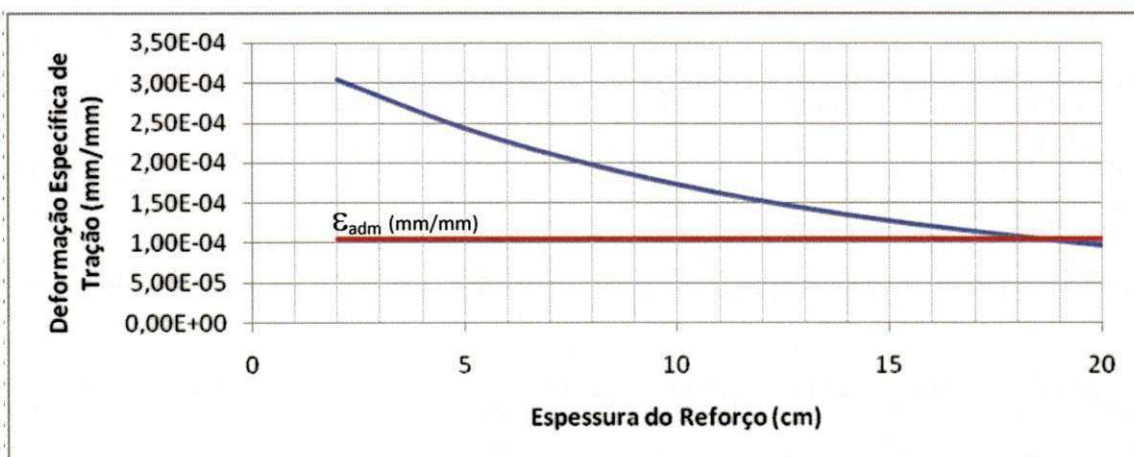
Figura 4.20 – Determinação da Espessura de Reforço Necessário para Garantir a Vida de Fadiga, Utilizando o Conjunto de Módulos Resultante da Retroanálise 4.
