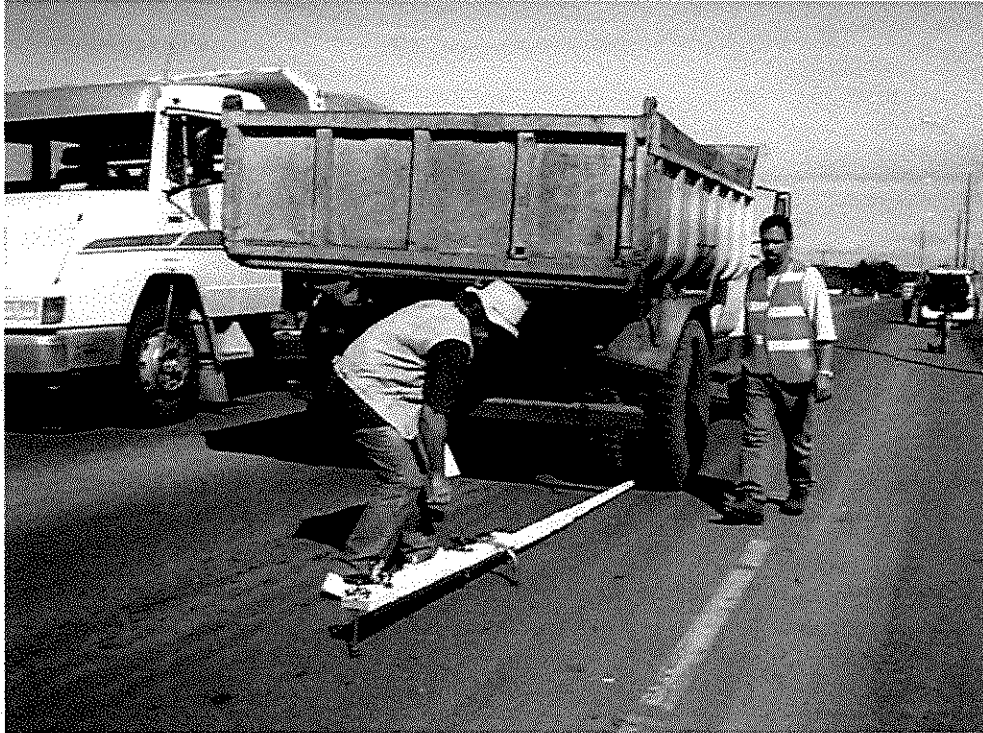
Figura 2.8 – Ilustração do ensaio realizado com a viga Benkelman (MOTTA e MEDINA, 2003).
