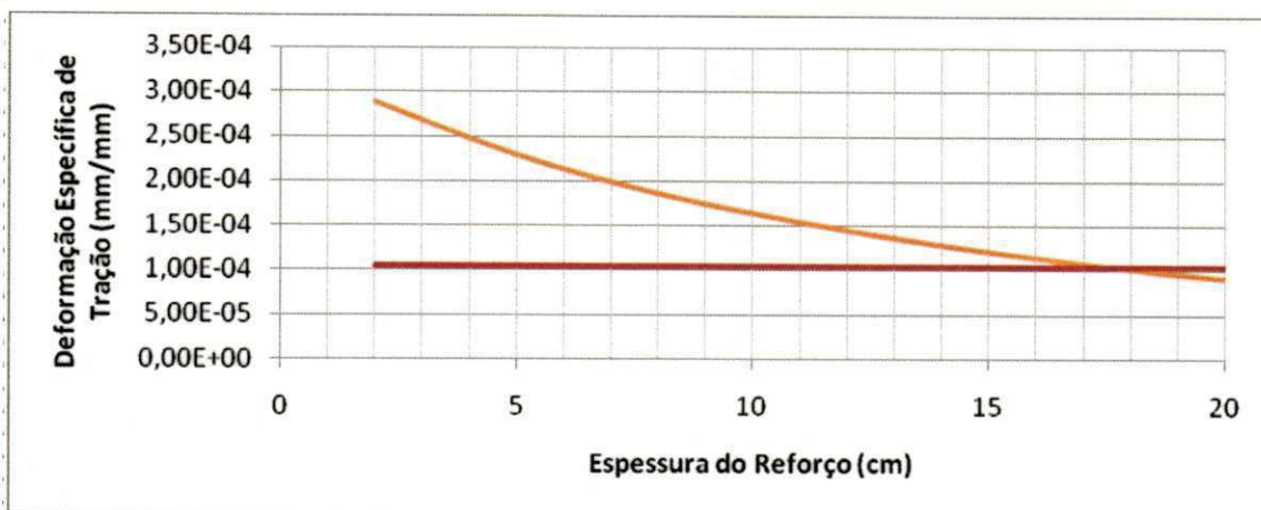
Figura 4.18 – Determinação da Espessura de Reforço Necessário para Garantir a Vida de Fadiga, Utilizando o Conjunto de Módulos Resultante da Retroanálise 2.
