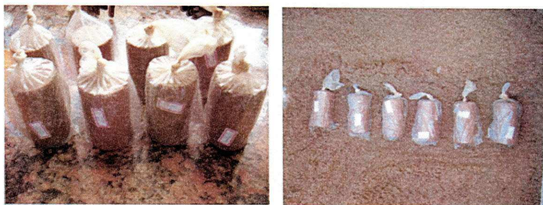
Figura 3.3 - A) Corpos de prova acondicionados em sacos plásticos. B) Corpos de prova armazenados em câmara úmida.
