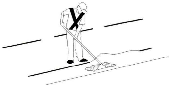
Figura S111– Limpeza do acostamento
