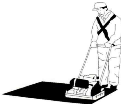
Figura T15 – Compactação do revestimento de um remendo profundo
