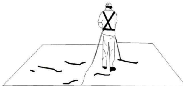
Figura T33 - Selagem das trincas
