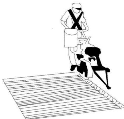
Figura S129 – Corte e retirada do revestimento para retirada da área afetada
