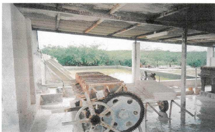
Figura 2.2 – Prensa do caulim em forma de blocos
