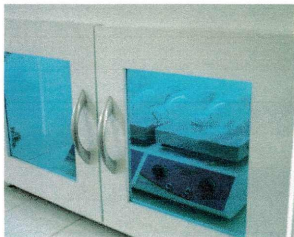
Figura 4.11 – Garrafas expostas à radiação UV das lâmpadas fluorescentes germicidas 15W (NARDS) no Laboratório de Química Ambiental da UEPB (CG/PB – 11/05/06)
