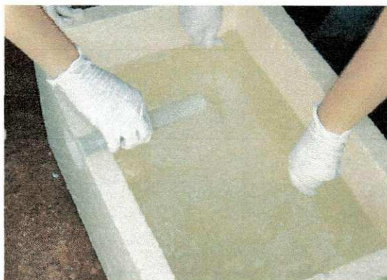
Figura 4.8 – Adição de esgoto e homogeneização da água B (São José do Sabugi/PB -16/12/05)
