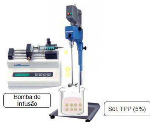
Figura 11: Representação Esquemática da produção das esferas
