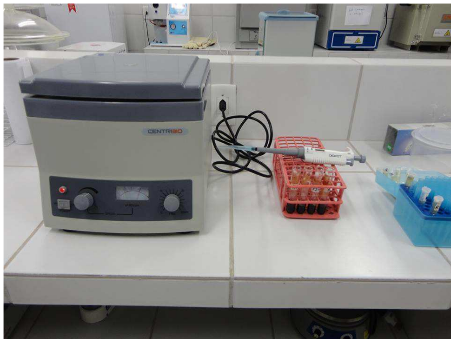
Figura 5. Centrífuga da marca Centribio® utilizada na pesquisa para separação do plasma. Fonte: Própria (2014).
