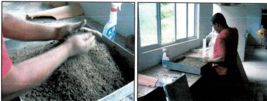
Figura 5.11 – Determinação do teor ótimo de água na mistura de Solo-cimento e casca de arroz.
