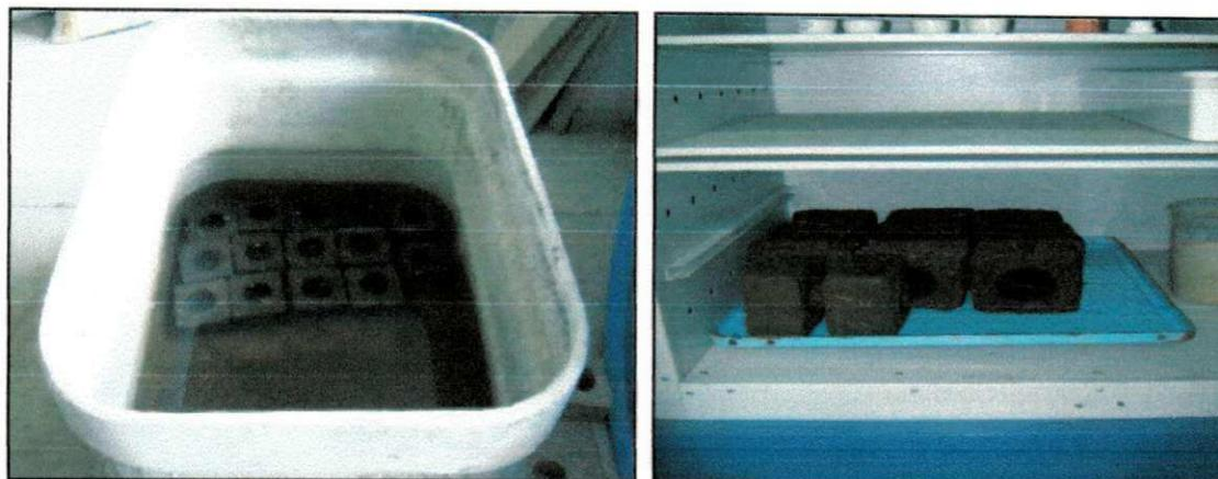
Figura 5.19 – Blocos de solo-cimento e casca de arroz imersos em água e na estufa com temperatura de (105°C e 110°C).
