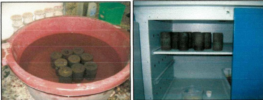
Figura 5.15 – Ensaio de absorção de água dos corpos-de-prova
