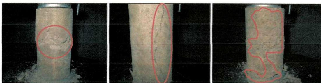
Figura 6.15 – Tipos de fissuras apresentados pelos corpos-de-prova após ensaios de compressão simples.
