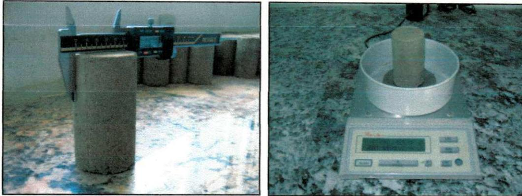
Figura 5.16 – Ensaio para determinar volume e massa dos corpos-de-prova
