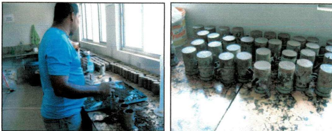
Figura 5.12 – Processo de moldagem dos corpos-de-prova.
