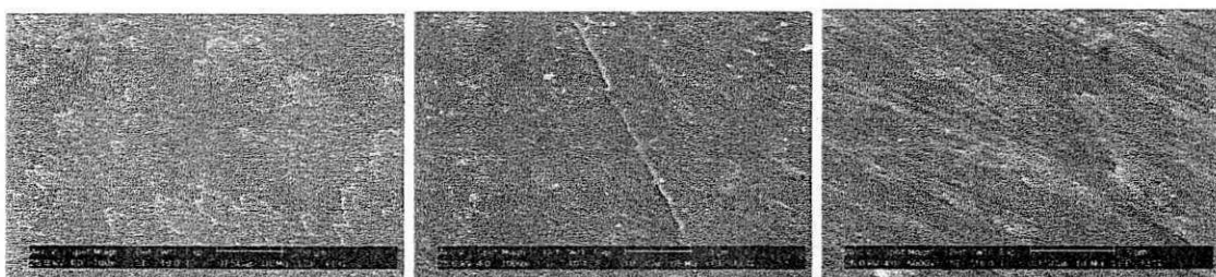
Figura 16: MEV da superfície de amostras NiTi Grupo 2 (55 % Ni) não irradiadas com aumentos de: 500x, 1000x, 5000x respectivamente (FILHO, 2010).
