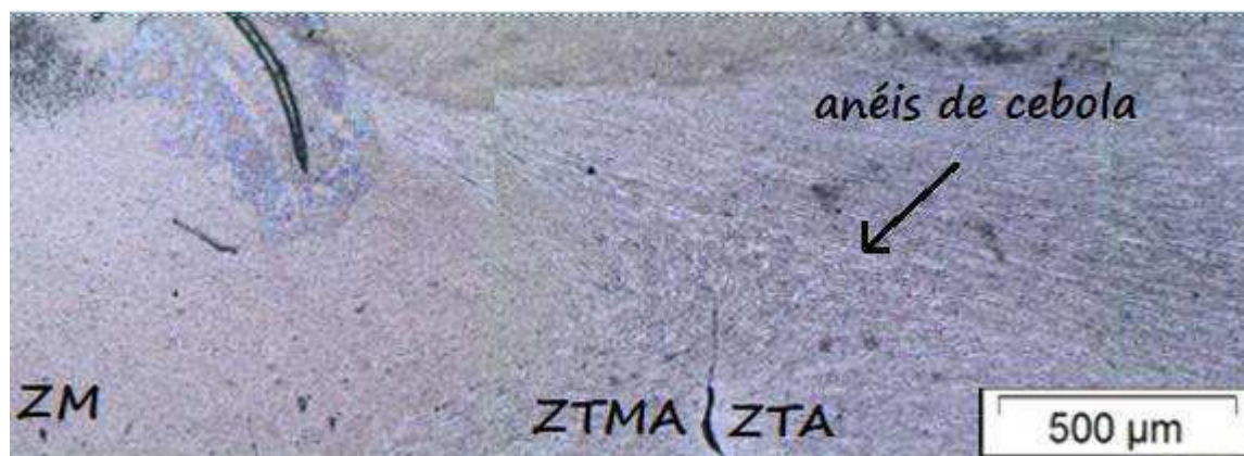
Figura 38: Microestrutura da região de transição entre as zonas misturada, termomecanicamente afetada e termicamente afetada.
