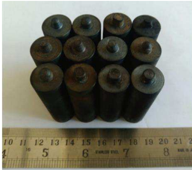
Figura 15: Ferramentas de soldagem confeccionadas em 12 perfis diferentes de pinos.
