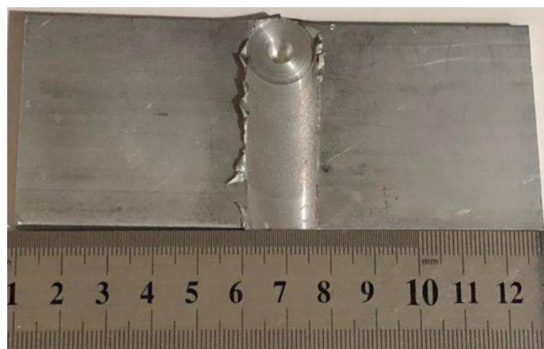
Figura 24: Dimensão da placa soldada pelo processo FSW.
