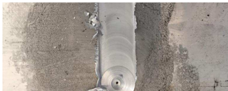
Figura 11: Defeito superficial do tipo excesso de rebarba de uma chapa de alumínio soldada pelo processo FSW.
