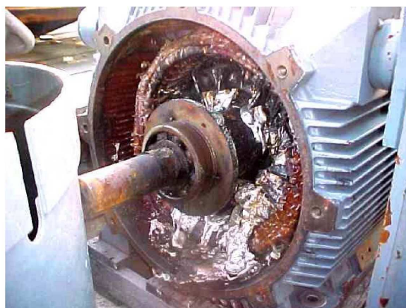
Figura 1.2. Motor de indução completamente destruído após a ocorrência do sobreaquecimento do mesmo, causado por algum tipo de falha.
