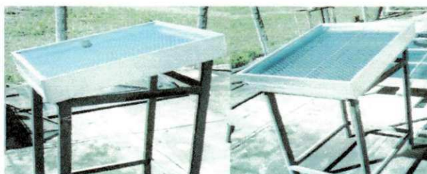
Figura 2.17. Secador solar de radiação direta desenvolvido na UFRN.
