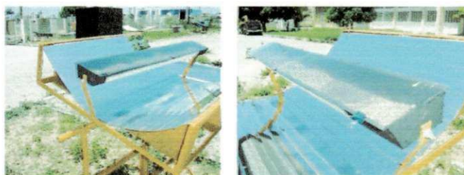
Figura 2.15. Secador solar com concentração desenvolvido na UFRN.
