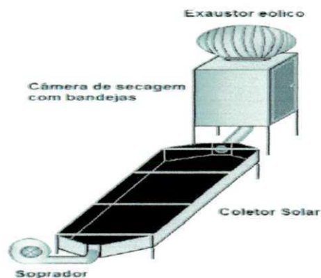
Figura 2.23. Sistema projetado do secador solar de radiação indireta com convecção forçada.
