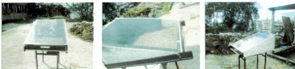
Figura 2.14. Secador solar de exposição direta desenvolvido na UFRN.
