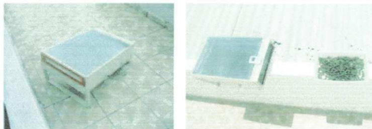
Figura 3.12. Cobertura de policarbonato transparente de 4 mm.
