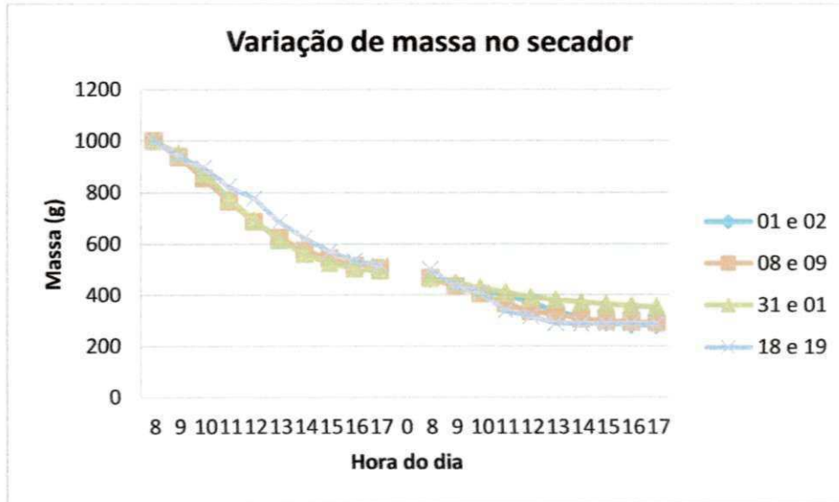
Figura 4.9. Comparativo da perda de massa de mamona no secador solar E1, E2, E3 e E4.
