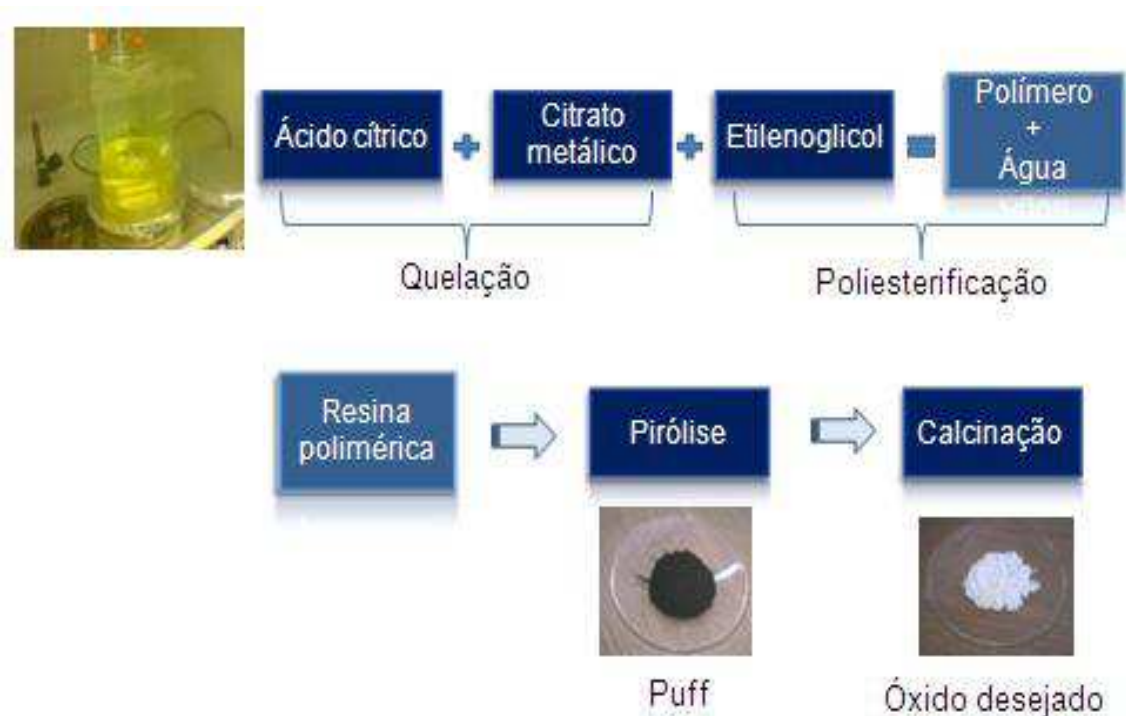
Figura 8 - Sequência da síntese de materiais utilizando o método Pechini.
