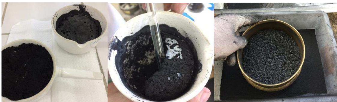
Figura 5 – Amostras pirolisadas, maceradas e peneiradas.
