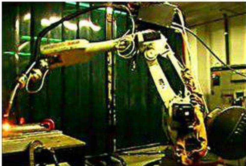
Figura 31 – Soldagem robotizada com arame tubular na posição plana.
