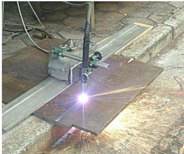
Figura 27 – Corte mecanizado da chapa de aço API 5L X80 com equipamento de corte à plasma.
