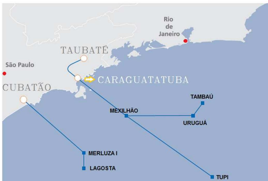
Figura 7 – Projeto de Malha de dutos na Bacia de Santos com uso de tubos de aço API 5L X80.
