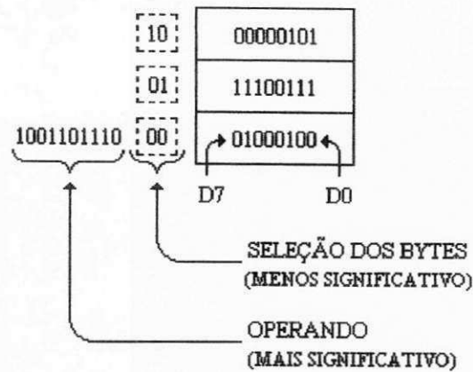
Figura 2.6 - Operação de Quadrado Ocupando Várias Locações
