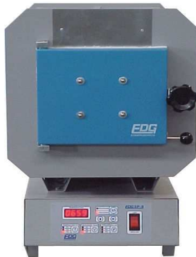
Figura 3.3 - Forno EDG utilizado na queima dos corpos de prova
