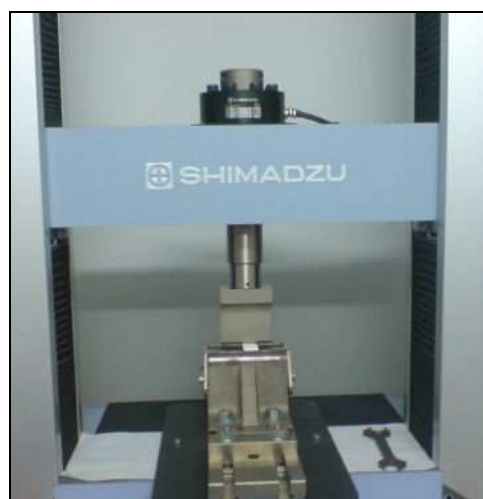
Figura 3.4- Aparelho utilizado para determinação do módulo de ruptura a flexão Fonte: Pesquisa Direta, 2009.
