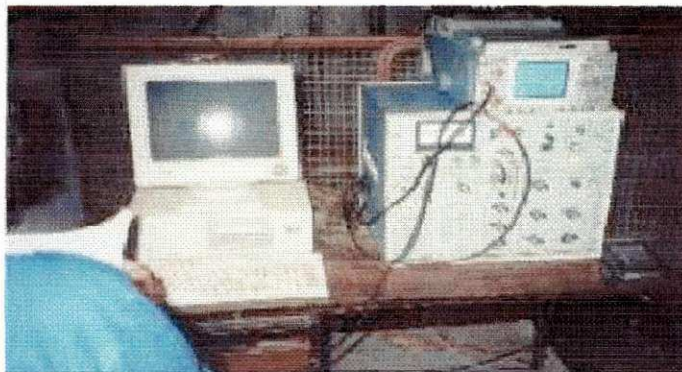
Figura 3.10 - Fotografia do detector de descargas parciais, do osciloscópio e do computador pessoal.
