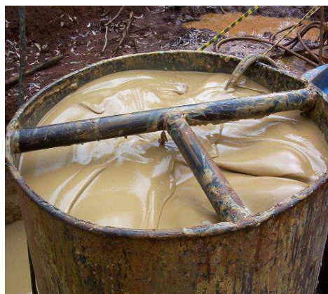
Figura 2 - Fluido de perfuração argiloso.
