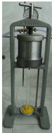
Figura 15 - Filtro-prensa API Fann.
