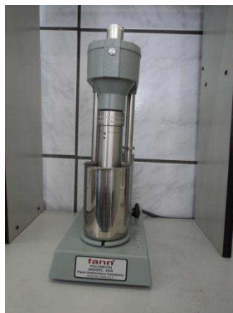
Figura 14 - Viscosímetro Fann 35A.
