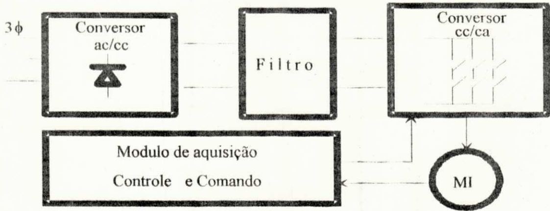
Fig. 1 - Representação em diagrama de blocos de um sistema de acionamento típico.
