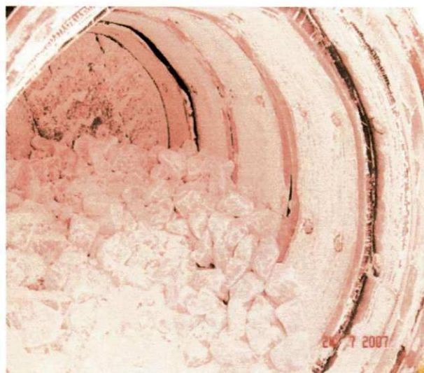
Figura 5 - Fotografia mostrando o revestimento interno do moinho.
