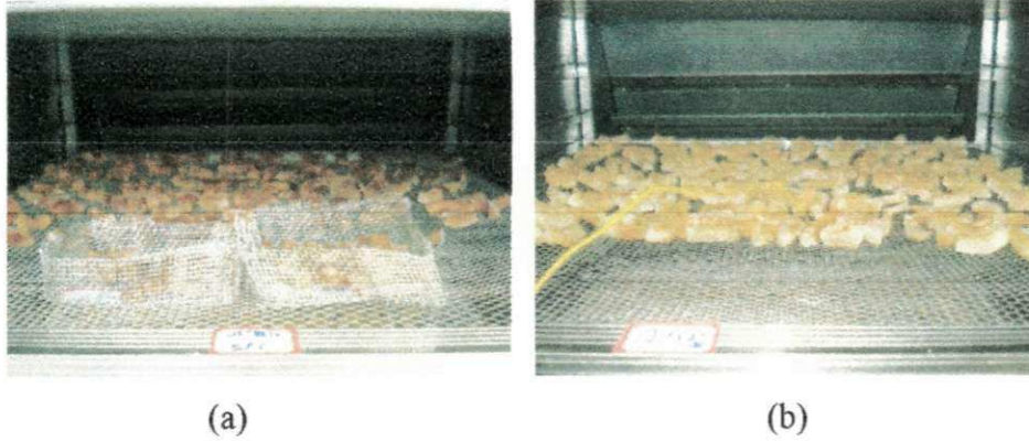
Figura 3.40- Tiras de coco maduro desidratado com tratamento preliminar a 25 °Brix e secagem a 50°C (a) e 60°C (b)
