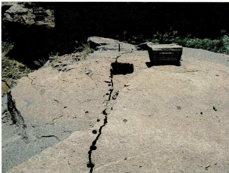
Figura 2.3: Frente de lavra em matacões em uma pedreira em Casserengue-PB.
