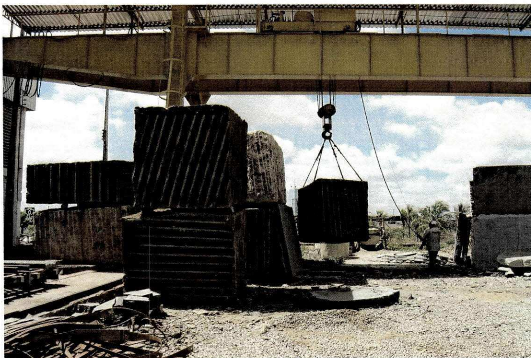
Figura 4.26: Pórtico de blocos de rochas ornamentais na Granfuji .
