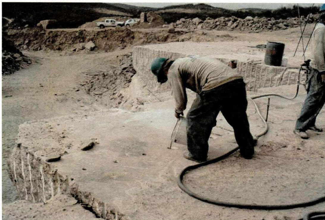
Figura 2.10: Operação com massa expansiva para obtenção de bloco, em uma pedreira localizada em Picuí – PB.
