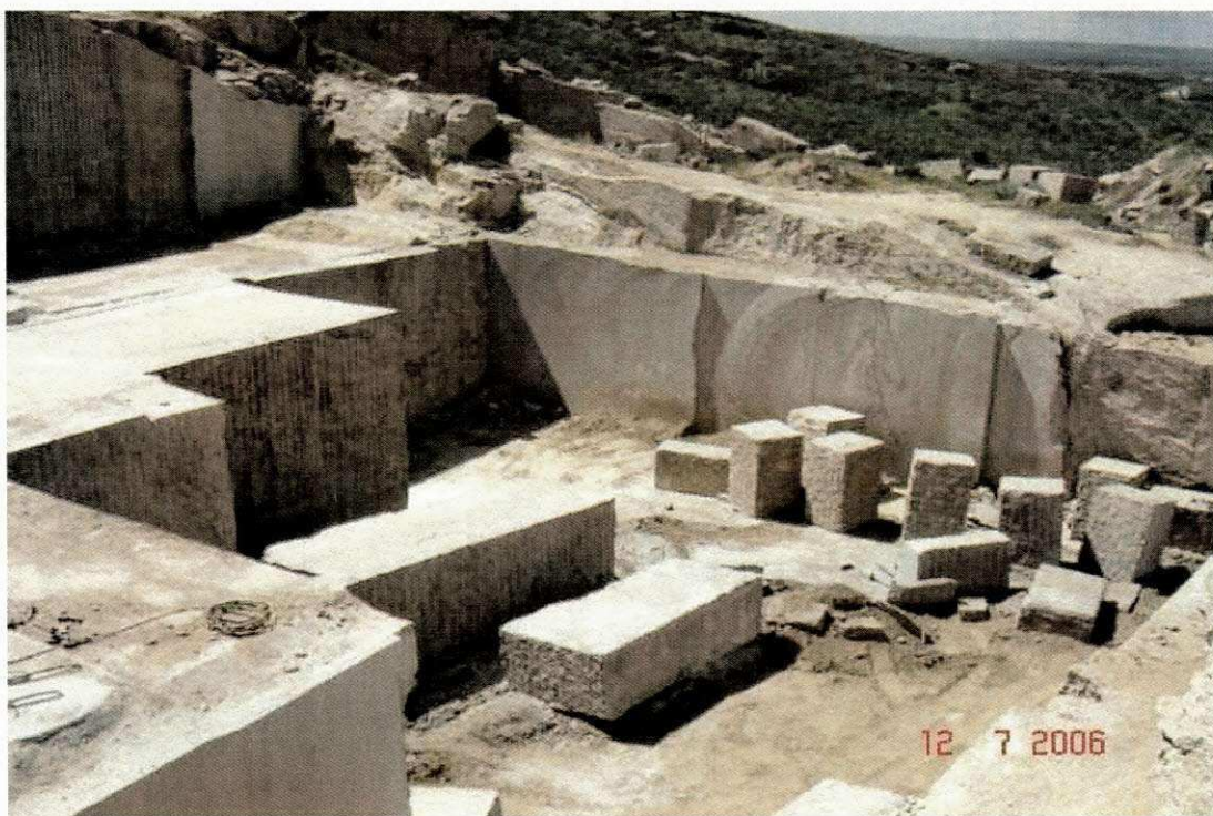
Figura 2.6: Lavra em maciço rochoso através de painéis verticais de um pedreira de granito Bordeaux em Picuí-PB.
