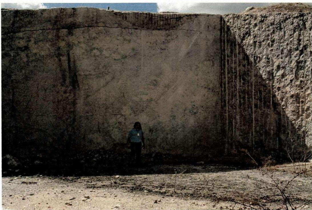
Figura 2.5: Frente de lavra experimental para lavra em maciço rochoso com metodologia de bancada alta em uma pedreira de Seridó-PB.
