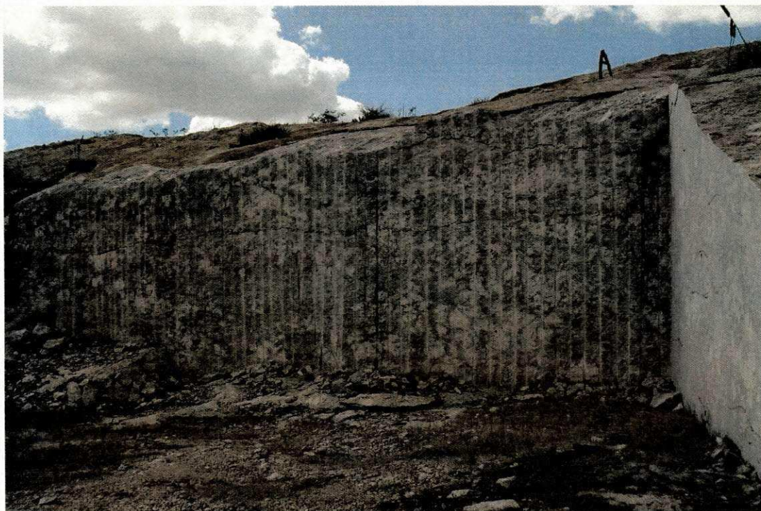
Figura 2.4: Frente de lavra experimental para lavra em maciço rochoso com metodologia de bancada baixa, em Pedra Lavrada – PB
