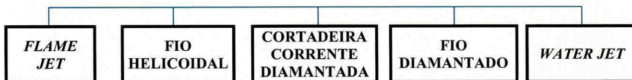
Figura 2.11: Tecnologia contínua de corte para desmonte primário de rochas ornamentais. Fonte: Modificado de Roberto (1998).
