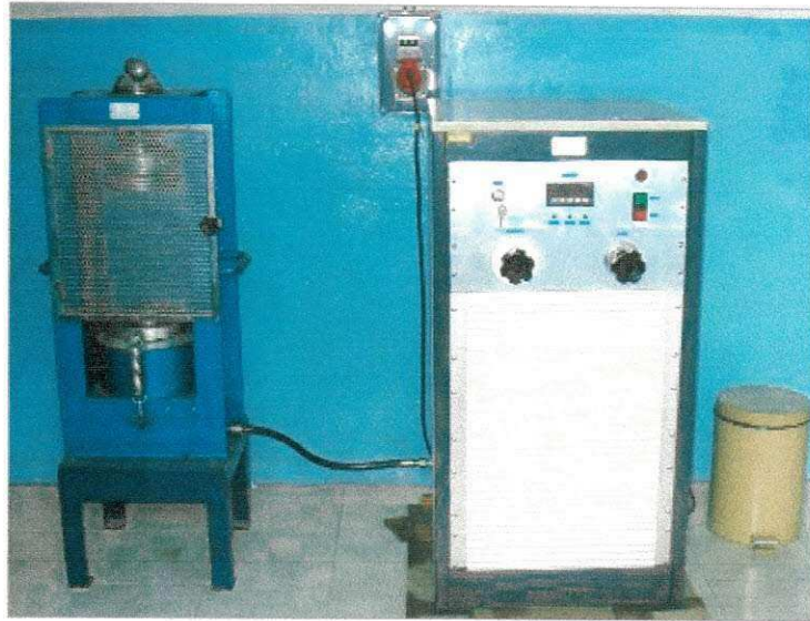
Figura 30 – Prensa hidráulico-eletrônica para ensaios de compressão
