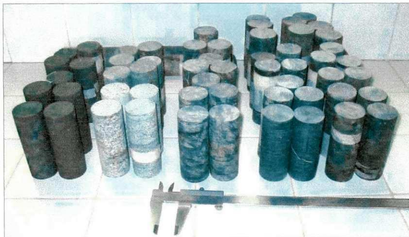
Figura 28 – Amostras preparadas para os ensaios de compressão
