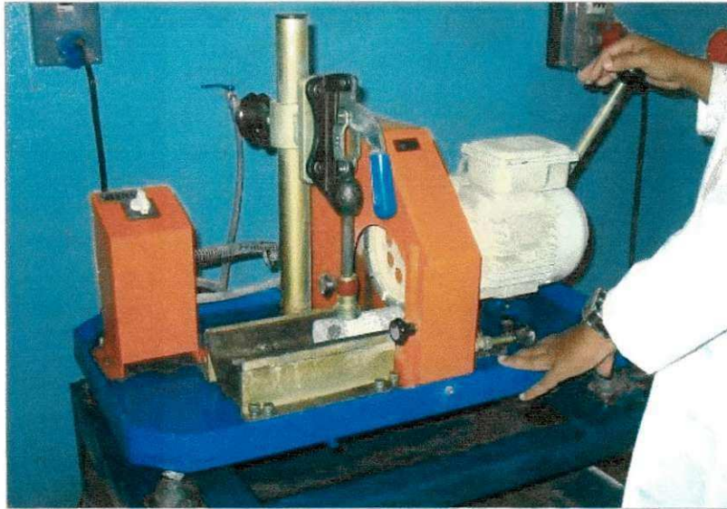
Figura 27 – Retífica das faces dos corpos-de-prova
