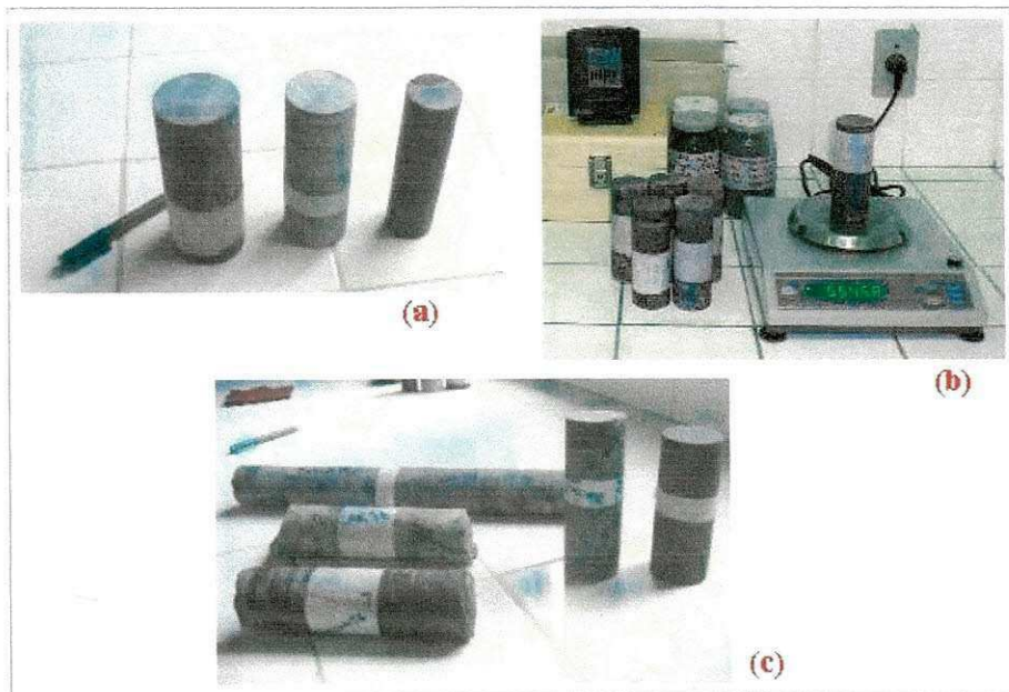
Figura 29 – Diâmetro dos corpos-de-prova (a), pesagem das amostras (b) e testemunhos descartados (c)
