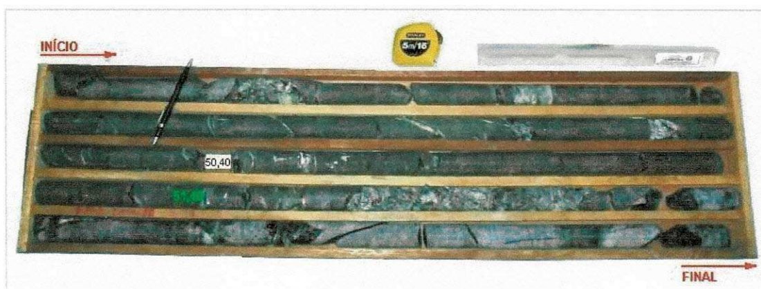
Figura 12 – Análise da recuperação e do RQD dos testemunhos do furo (562/S-13R)
