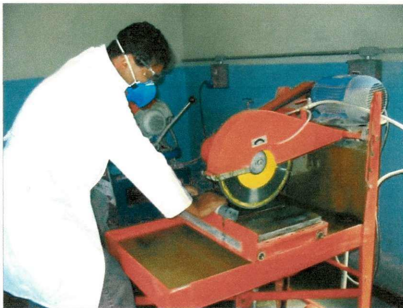
Figura 26 – Corte dos testemunhos de sondagem para preparação dos corpos-de-prova
