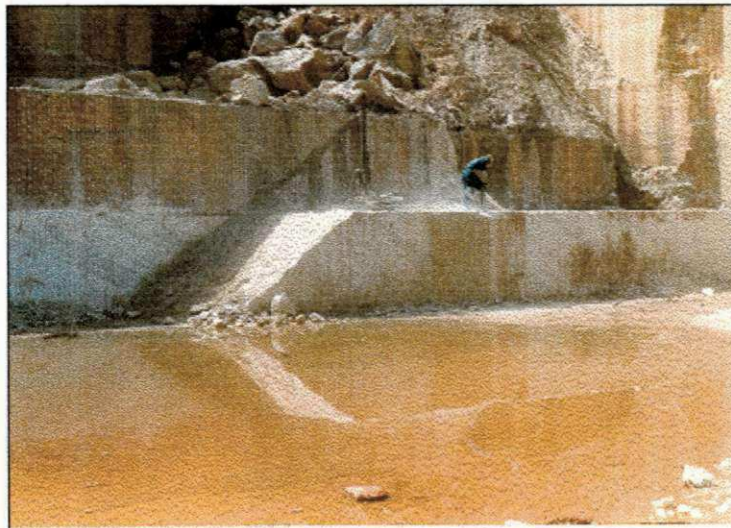
Foto 3.4- Praça de trabalho com conjugação de método de perfuração contínua com fio helicoidal (a fratura oblíqua serviu de plano para formação de rampa de acesso a nível independente).
