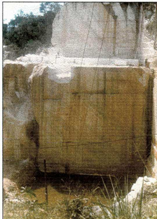
Foto 3.2- Detalhe de duas bancadas altas, onde, além do desmonte primário é destacado serviço de desbaste de blocos.
