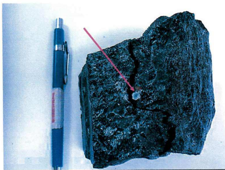
Fotografia 5 – Deformação plástica na amostra
