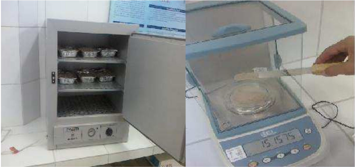
Figura 4: Amostras de sedimento colocado em recipientes de alumínio e acondicionado há estufa para secagem no LABMeio/CES/UFCG.
