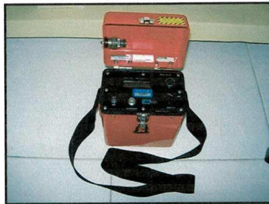
FIGURA 19 – Unidade de leitura utilizada para registrar as deformações captadas pelo medidor de deformação em furo de sonda.
