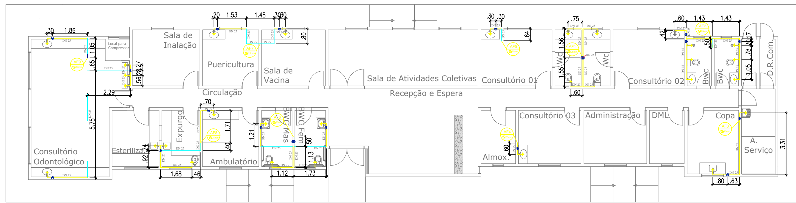
Instalações Hidráulicas Pontos de Utilização
