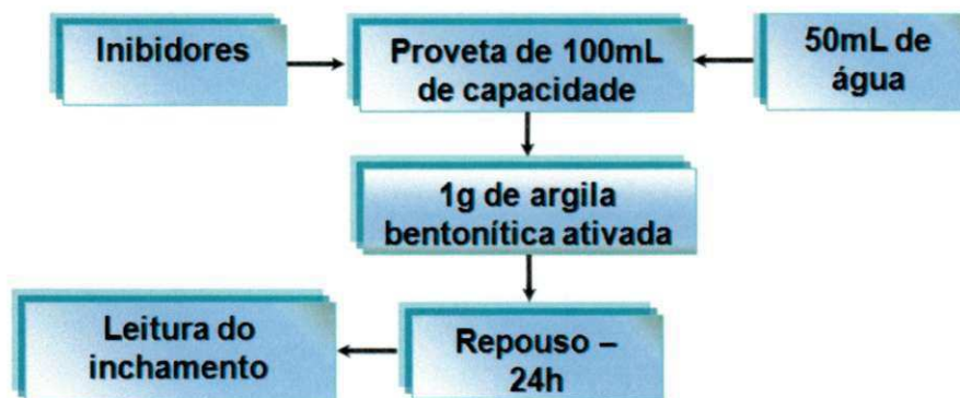
Figura 9: Fluxograma das etapas realizadas para a obtenção do grau de inibição de argilas expansivas dos inibidores químicos utilizando método de Inchamento de Foster.
